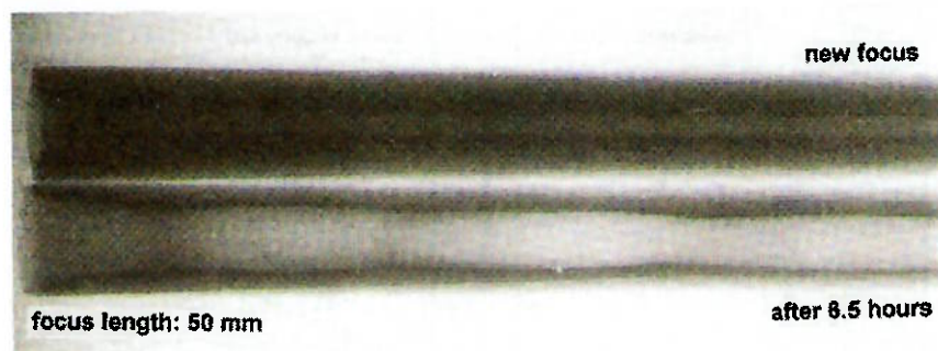
Figura 4.13: Fotografia ampliada em corte de um bico após o uso de 6,5 horas.
